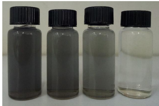
شکل ۳، نمونه های سیال و نانوسیال استفاده شده به ترتیب از راست، غلظت صفر (آب) و غلظت های ۰/۰۰۱، ۰/۰۰۵ و ۰/۰۱ درصد وزنی از نانوسیال اکسید آهن در آب
