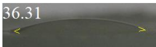
شکل ۳- تصویر زاویه تماس قطره آب با نانوذرات نشاسته تولید شده در شرایط مطلوب
