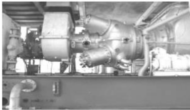
شکل ۳- توربو کمپرسور روستون (Ruston) مدل TB4000 پالایشگاه سرخون و قشم.
