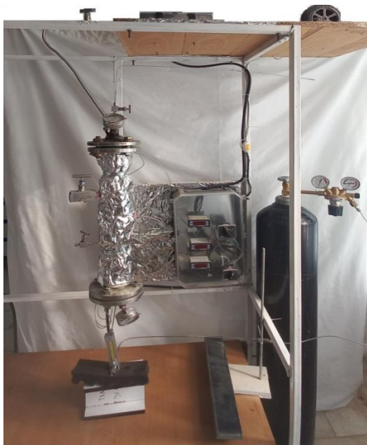
شکل ۲. دستگاه آزمایشگاهی طراحی شده برای انجام آزمایشات جذب سطحی
