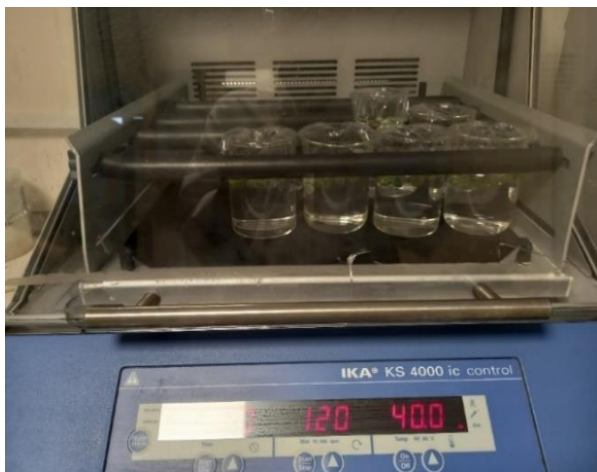
شکل ۲. تصویری از دستگاه شیکر انکوباتور استفاده‌شده در روش ناپیوسته.
