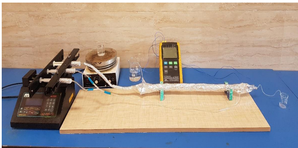
شکل ۱. سامانه آزمایشگاهی میکرومبدل دولوله‌ای طراحی شده.
