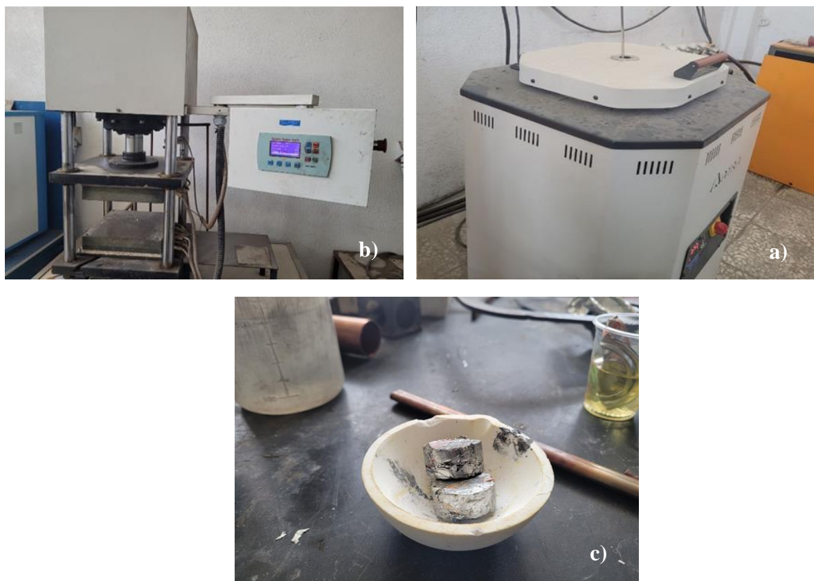
شکل ۱. عکس دستگاه‌ها: الف) کوره استفاده شده ب) دستگاه پرس استفاده شده ج) بوته اکسید آلومینیوم و آلومینیوم قرصی شکل
