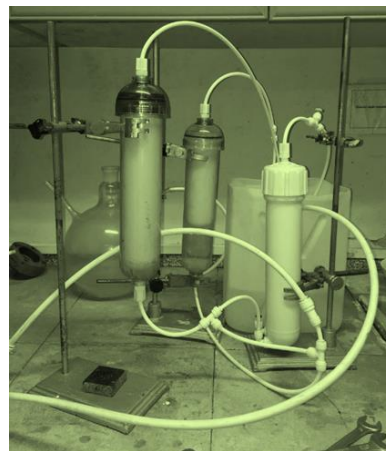
شکل ۱. غشاهای لوله‌ای M_1 ، M_2 و M_3 ماژوله شده برای آزمون کدورت‌سنجی.
