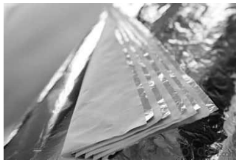
شکل ۷. لایه های بازتابنده و فاصله دهنده MLI [۲۷].
