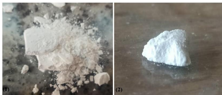
شکل ۴. تصویر ظاهری از آئروژل سیلیکا در غیاب (۱) و حضور CTAB (۲).
