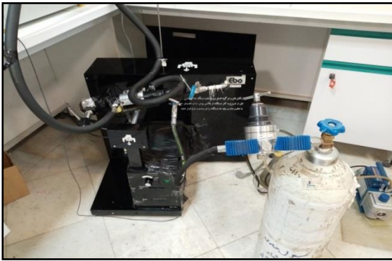
شکل ۳. تصویر راکتور نوسانی الکتریکی مورد استفاده برای آزمون‌های هیدرات گازی.
