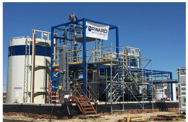
شکل ۱۲. پایلوت پلنت ZLD مبتنی بر فرایند اسمز مستقیم [۵۱].
