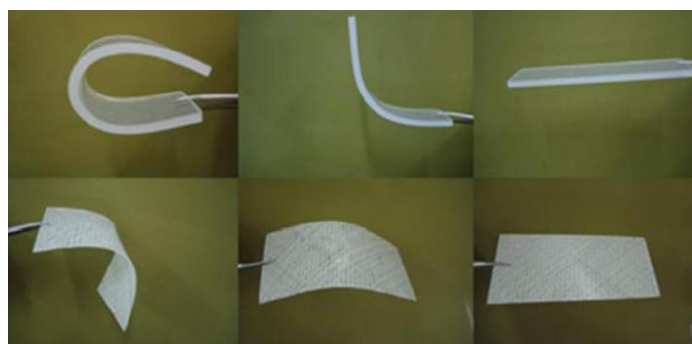
شکل ۳. ردیف اول: برگشت یک ماده حافظه شکل خالص، ردیف دوم: بازگشت همان ماده به علاوه الیاف شیشه [۶]. Figure 3. First row: return of a pure shape memory material, second row: return of the same material plus glass fibers [6].
