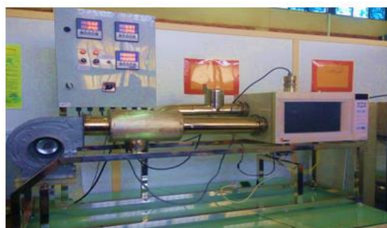
شکل ۱. شماتیک و خشک‌کن ترکیبی همرفتی-فرورسرخ استفاده شده. ۱- فن مکند ۲-لوله های انتقال هوا ۳-المنت‌های حرارتی ۴-توزیع کننده هوا ۵-محفظه خشک‌کن ۶-لامپ فرورسرخ ۷-صفحه نمایش و تابلوی برق
