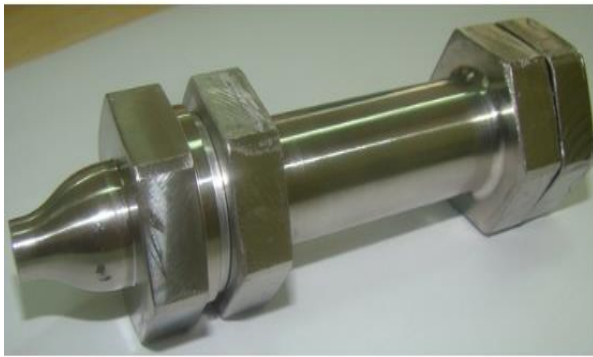
شکل ۲. تصویر نمونه ساخته شده مدل طراحی و آزمایشی شامل نازل و راکتور رانشگر فضایی.
