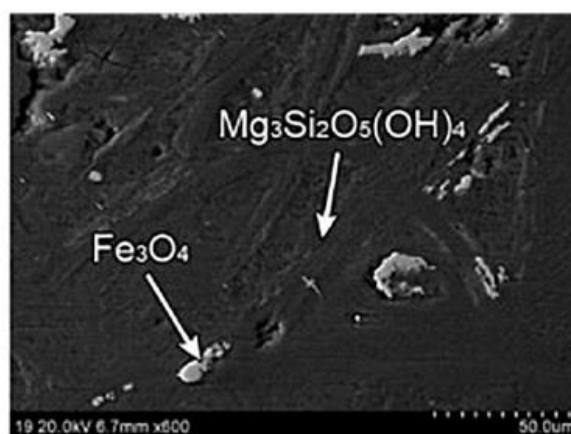
شکل ۲. سمت چپ عکس و سمت راست تصویر الکترونی روبشی سرپانتیت [۴۱].
