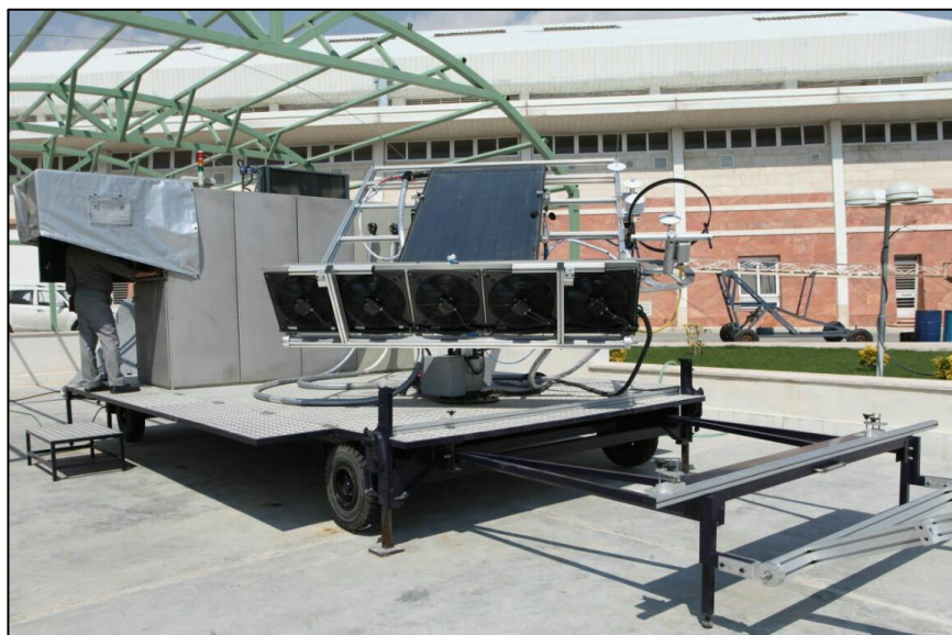
شکل ۱. نمایی از بستر آزمون تجهیزات خورشیدی حرارتی پژوهشگاه صنعت نفت.
