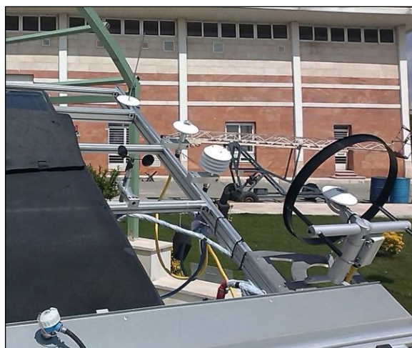
شکل ۲. حسگرهای اندازه‌گیری شدت تابش (کل و پراکنده)، دمای محیط و سرعت باد.
