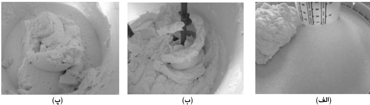
شکل ۱. مراحل مختلف مخلوط و تهیه کردن پوشش عایق حاوی ایزوژل: (الف) مواد اولیه؛ (ب) مرحله مخلوط کردن؛ (پ) ترکیب نهایی پوشش عایق [۵].
