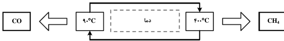
شکل ۴. چرخه ترمواستاتی حساس به متان و کربن مونواکسید [۷].
