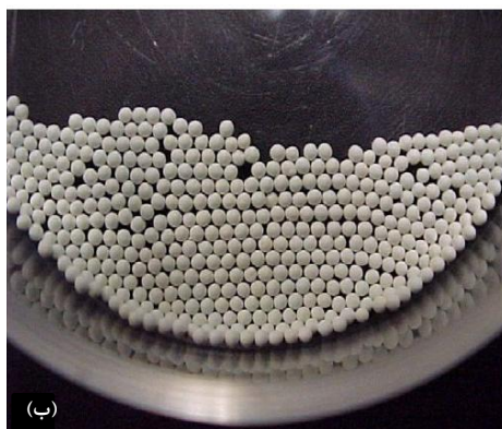
شکل ۶. کامپوزیت‌های کروی TiO_2 تولید شده (pH اولیه = ۱۲): (الف) در محلول NH_4OH و (ب) پس از حذف NH_4OH [۷].
