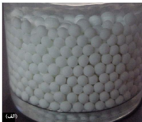
شکل ۶. کامپوزیت‌های کروی TiO_2 تولید شده (pH اولیه = ۱۲): (الف) در محلول NH_4OH و (ب) پس از حذف NH_4OH [۷].
