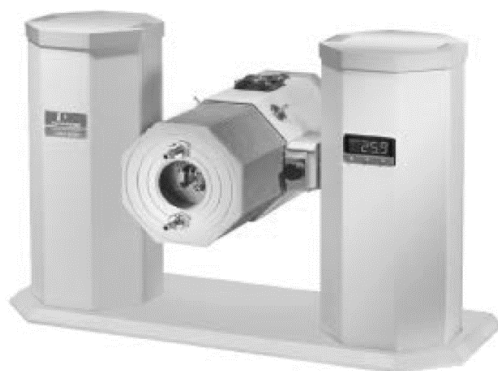
شکل ۱۳. نمایی از دستگاه DMA [۴۰].
