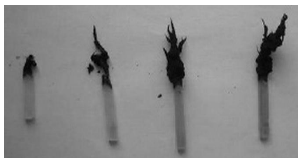
شکل ۷. نتایج عکسبرداری از نمونه‌ها بعد از انجام آزمون شاخص اکسیژن، (الف) EACGP0، (ب) EACGP10، (پ) EACGP15، (ت) EACGP20 [۲۷].
