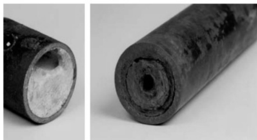
شکل ۶- نمونه‌هایی دیگر از خوردگی و رسوب ناشی از کری اور در لوله‌های دیگ بخار [۱]
