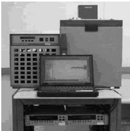
شکل ۵- تصویر یک گرماسنج حالت جامد با دقت بالا در حمام آب به همراه یک لپ تاپ IBM جهت جمع آوری داده‌ها [۵]
