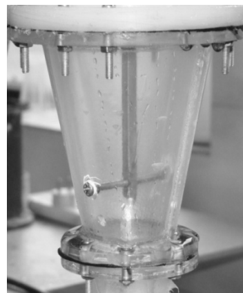
شکل ۵- اتصال میله افقی و عمودی در قسمت مخروطی
