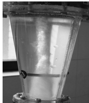
شکل ۱۲- کم شدن قطر و بیشتر شدن ناپایداری با اضافه شدن میله افقی
