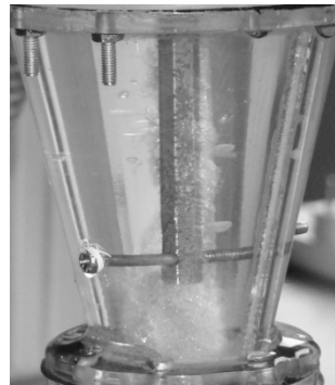
شکل ۱۳- میله‌های افقی و عمودی در قسمت مخروطی و حذف هسته هوایی
