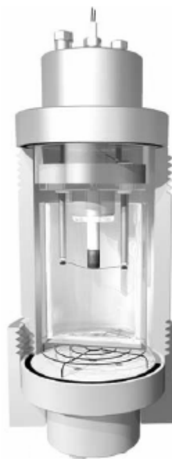
شکل ۶- تصویر محفظه احتراق (بمب NFWB) شامل مخزن، نگهدارنده نمونه، نمونه و سیم (نیکل- کروم) جهت اشتعال [۸]
