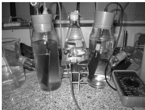
شکل ۱- نمای اجمالی و عملیاتی پیل سوختی زیست‌شناختی در مقیاس آزمایشگاهی (الف) نمای اجمالی یک پیل سوختی زیست‌شناختی دارای دو محفظه مجزا، (ب) پیل سوختی زیست‌شناختی ساخته شده و در حال کار
