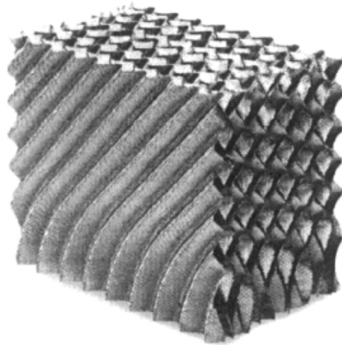
شکل ۸- ساختار اصلاح شده ملاپک پلاس نسبت به ملاپک. جهت چین خوردگیها در ابتدا و انتهای آکنه به سمت محور قائم سوق داده شده است [۹].
