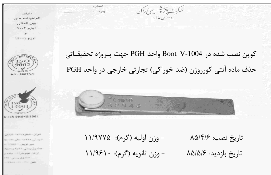
شکل ۶- عکس کوپن قرار داده شده در مسیر آب خروجی V-1004 پس از یک‌ماه کارکرد
