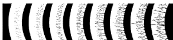
شکل ۲- مراحل پیشرفت خوردگی خزشی در جداره یک لوله
