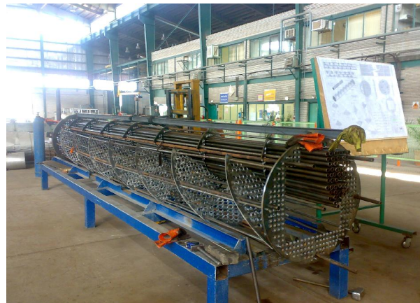
شکل ۸- نمایی از نصب مجموعه بفللهای روی دسته‌لوله
