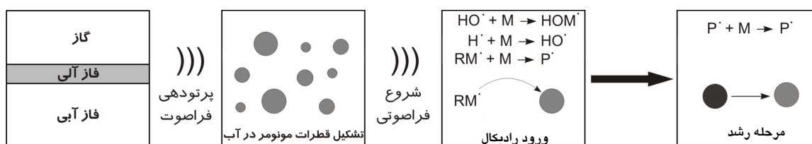
شکل ۱۲- نمودار تصویری مکانیسم پلیمریزاسیون امولسیونی فراصوتی [۱۶].
