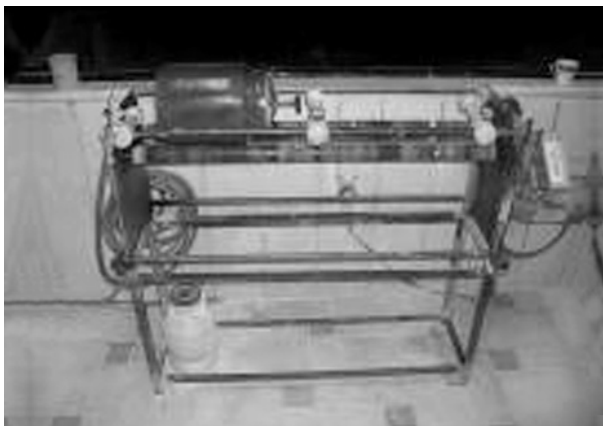
شکل ۲ - نمونه جارمیل مورد استفاده جهت آسیاب مواد
