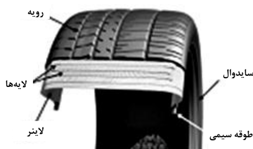
شکل ۱. بخش‌های گوناگون تشکیل دهنده تایر.
