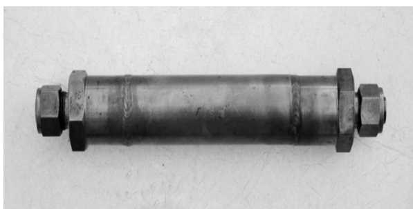
شکل ۲. نمونه واکنشگاه لوله‌ای با بدنه‌ای از جنس استیل.
