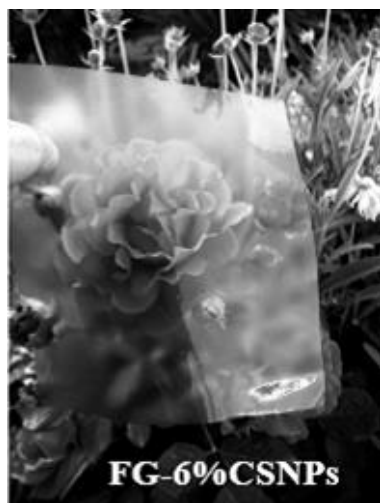
شکل ۷. تأثیر افزودن نانوذرات کیتوزان (CSNPs) بر روی شفافیت لایه ژلاتین ماهی [۳۵].
