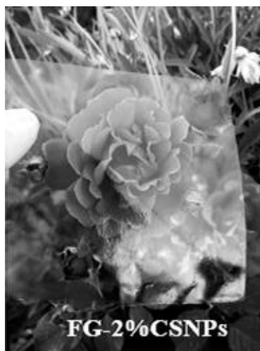
شکل ۷. تأثیر افزودن نانوذرات کیتوزان (CSNPs) بر روی شفافیت لایه ژلاتین ماهی [۳۵].
