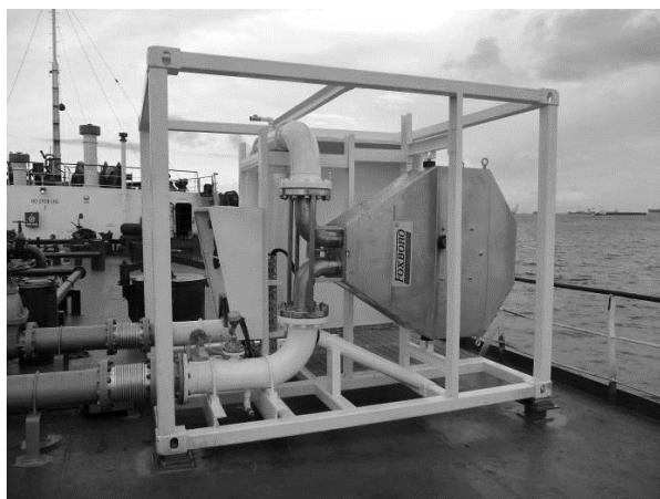
شکل ۲. تصویری از دستگاه کوریولیس [۳].
