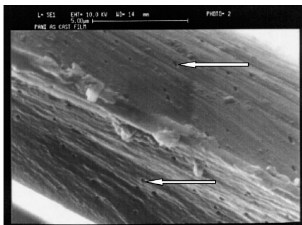
شکل ۴- تصویر SEM فیلم پلی‌آنیلین، منافذ با پیکان نشان داده شده است [۱۶]
